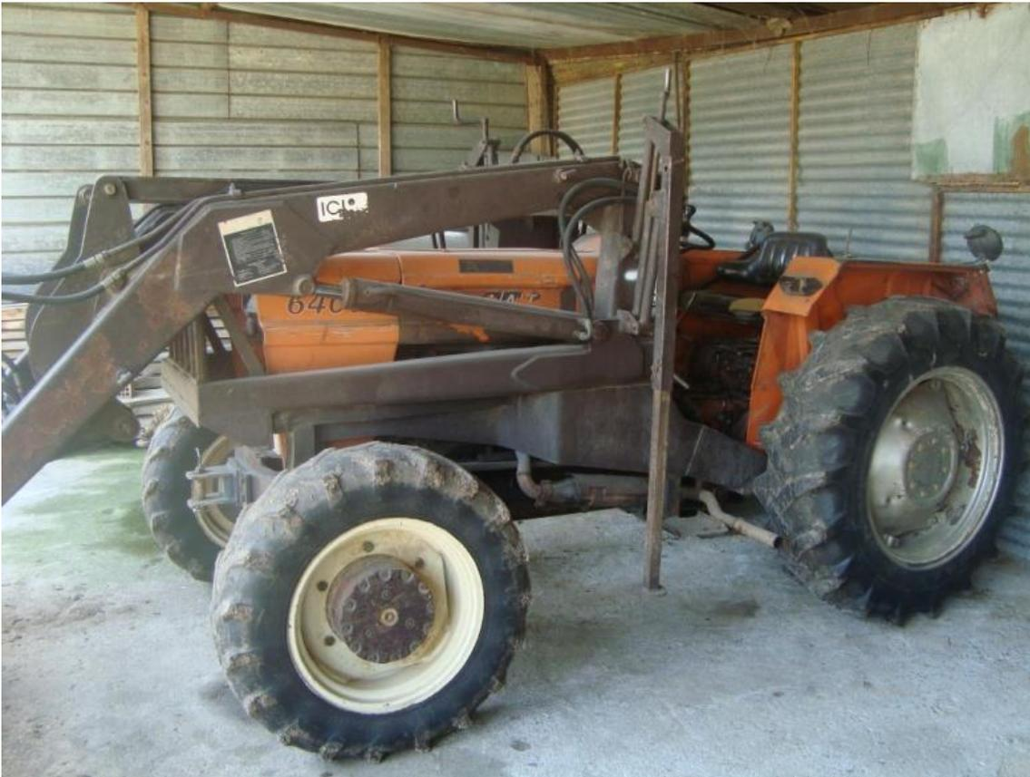
Figura 7. Trattorie da mettere fuori uso (sprovvista di telaio, cinture di sicurezza, con parti calde ed in movimento scoperte ed assenza di sistemi di accesso).
